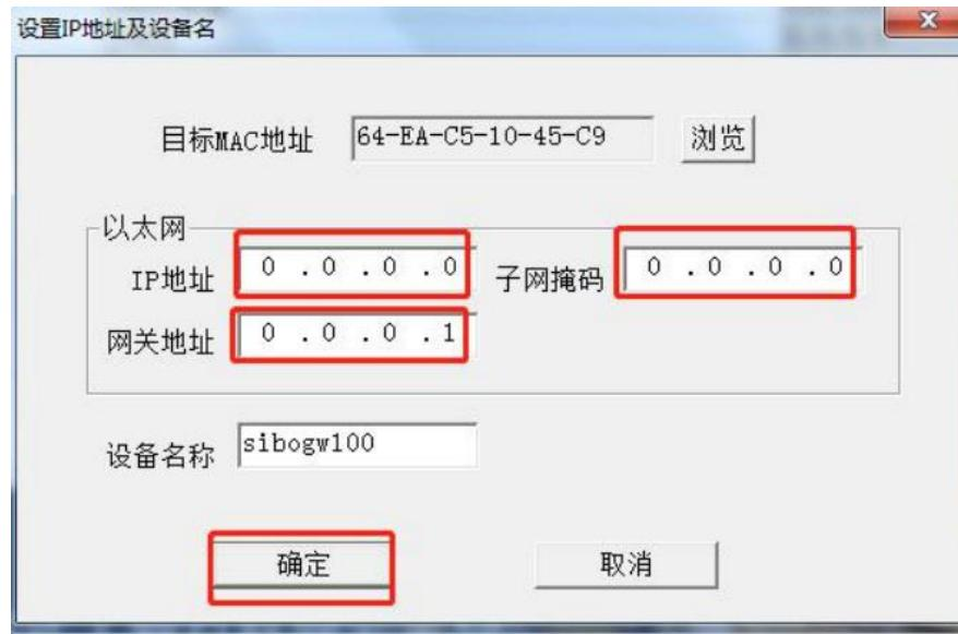
将“IP 地址”，子网掩码，网关地址分别设置为“192.168.0.18”，“255.255.255.0”，“192.168.0.1”，设置后，如下图示：
