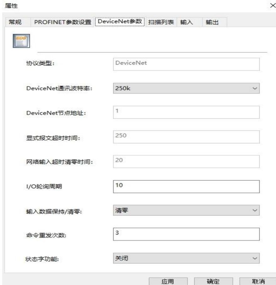
状态字功能：开启可以监视 DeviceNet 设备的连接状态，打开后，在 PROFINET 输入缓冲区最前面预留 8 字节，8 字节的每一个 bit，代表一个从站的状态，字节 0 的 bit0 代表 0 号 DeviceNet 从站，bit1 代表 1 号 DeviceNet 从站，bit2 代表 2 号 DeviceNet 从站，以此类推。而且 bit 位值为 1 时表示 DeviceNet 从站通信正常，bit 位值为 0 时表示 DeviceNet 从站离线。
