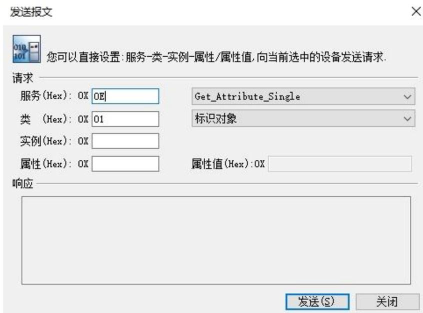
设备在线后，点击右键，可以进行“发送显式报文”操作，弹出的界面如上图所示，用户可以实现设置及获取属性操作，方便用户设备的在线调试。
