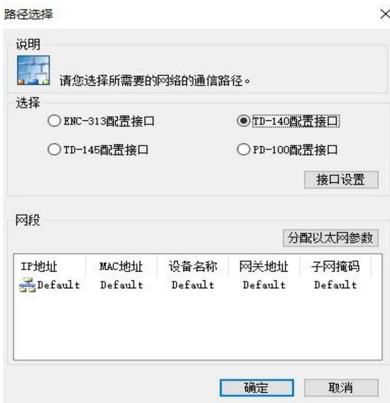
随后点击接口设置，软件将会将搜索到的设备显示在列表中，选中所需要配置的主站进行接口设置：
