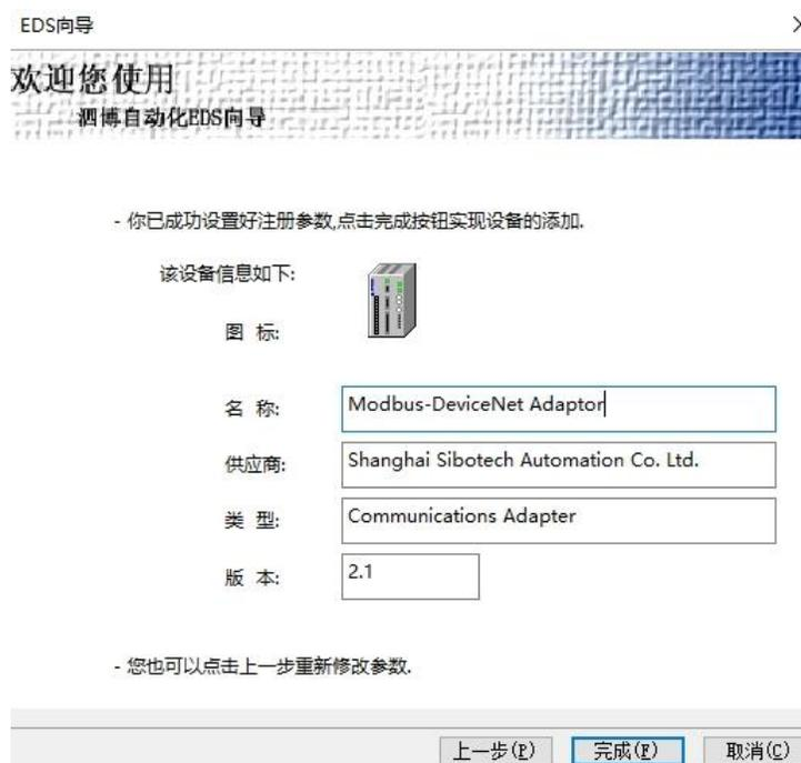
注册完成后，可以在设备管理窗口看到所注册的设备。用户同一设备的 EDS 文件如果有修改，请先在设备管理库中找到该设备，点击右键，选择注销后，重新注册新的 EDS 文件。
