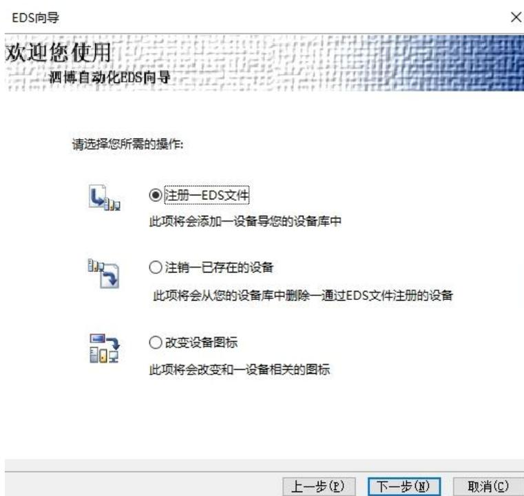
在此界面，用户可以进行注册一 EDS 文件、注销一已存在的设备、改变设备图标操作。
