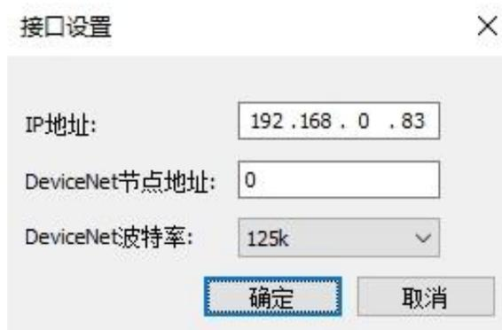
注意接口设置配置，“IP 地址”为搜索时选中的设备 IP，“DeviceNet 节点地址”为 DeviceNet 主网关的地址，设置 0~63 之间的任意值，不能与总线上其它节点地址冲突，“DeviceNet 波特率”为 DeviceNet 主站网关的波特率，125K、250K、500K 可选，保持总线波特率一致。
