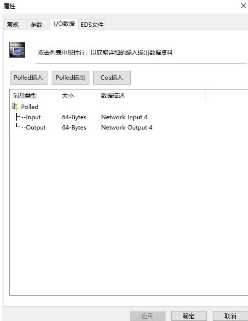
DNetStart 软件的输入/输出字节数也可以提供这些信息。在上图中，“Polled”这个项目下，提供的 Input 和 Output 64-Bytes 字节就是默认的输入输出数据字节长度（默认和实际的长度可能不一样）。
