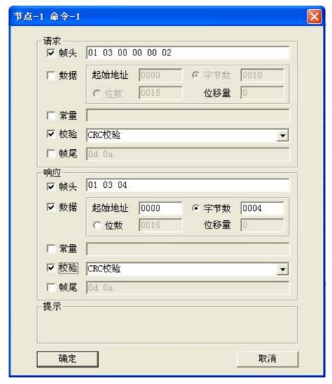
注:在RTU传输格式下,校验支持:无校验、CRC校验、和校验
