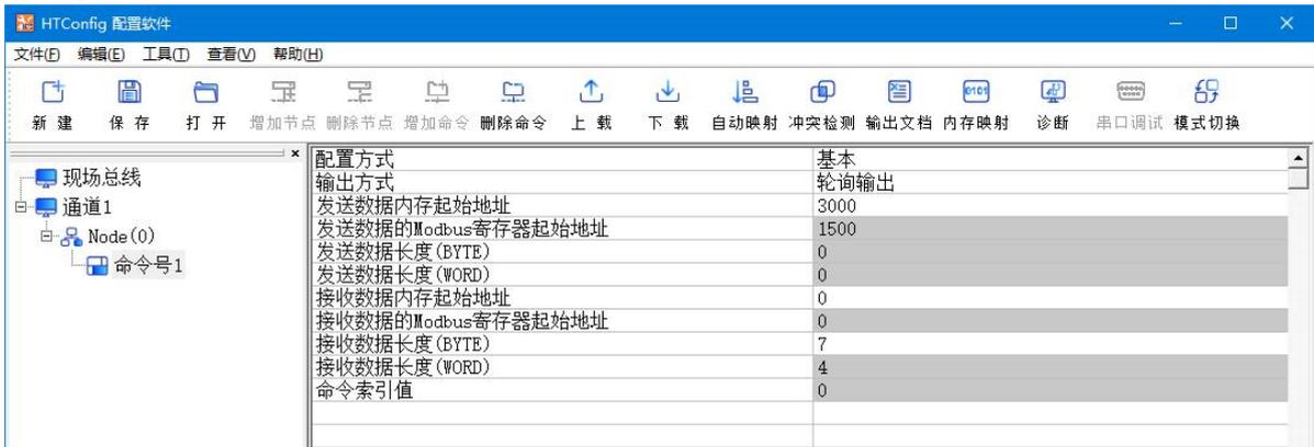
输出方式：可以选择此命令的执行方式，可以选择为逢变输出，轮询输出，初始化输出，不输出；
