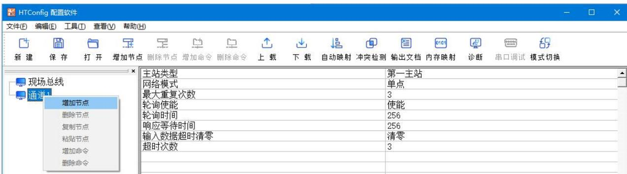
点击所增加的节点，在右侧的配置板块中设定从站的地址，单点模式下地址只能为 0，多点模式 1~15 可设。
