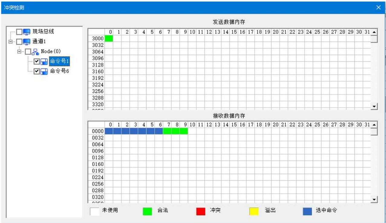
其中左侧的树视图中显示所配的命令，右侧为内存分配图。上面的内存分配图表示 HART 发送数据的内存分配，下面的表示 HART 接收数据的内存分配。当某一内存单元被两个或两个以上的命令所占用时，该内存单元将显示红色，当命令所分配的内存地址超出网关所规定的范围时，那么超出的部分将显示黄色，白色的区域表示可用的内存，绿色的区域表示已经被占用的内存。点击某一条命令，右侧的内存分配图将会以蓝色来表示该命令的输入数据和输出数据所在的存储位置。
