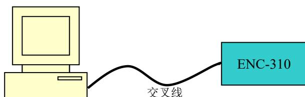
2. 用直连式网线连接 ENC-310、PC 机和以太网路由器（网关、Hub、交换机），如下图所示，
