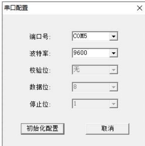
端口号为当前使用的串口，波特率为当前的串口波特率，即拨码开关设置的波特率。
