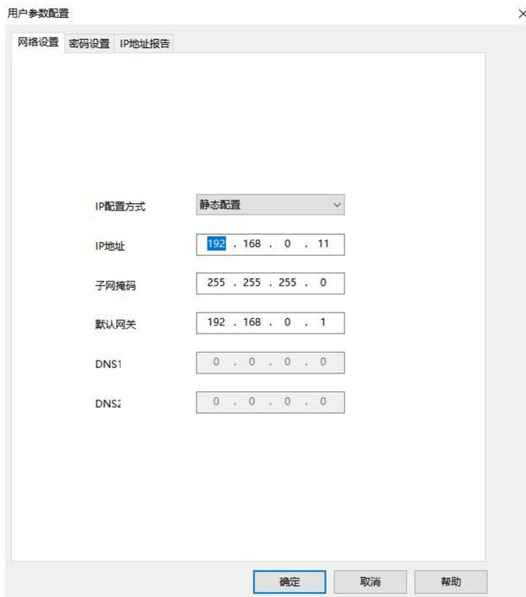
在这个界面，用户可以配置：网络设置、密码设置、动态 IP 获取。下面就依次介绍上述界面。
